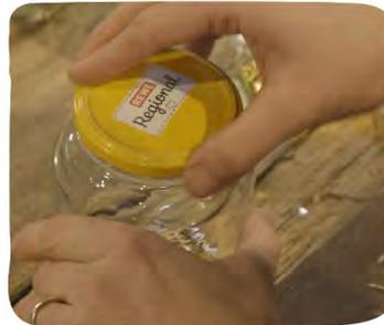
2. Den Deckel abschrauben und mit einer Bohrmaschinen-Fräse ein Loch - entsprechend der Größe der späteren Fassung - in den Deckel fräsen.
